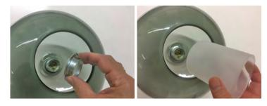
Bei Einsatz der Diffusorglases SG 15 (Zubehör nicht im Lieferumfang enthalten!) das innere zweite Distandrohr weglassen und sodann den Fassungsschraubring MIT DEM GEWINDEANSATZ ZUR GLASÖFFNUNG HIN aufschrauben. Sodann Diffusorglas aufschrauben.
